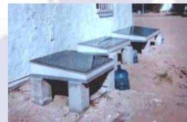
Distillatori solari. Messico
